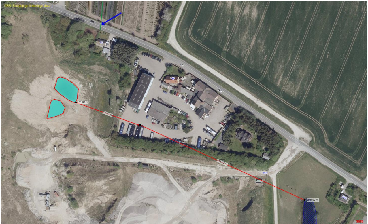
Figur 5 Afstanden fra indvindingsboringen til nærmeste beskyttede naturområder er 80 meter. Det drejer sig om to nyanlagte søer mod vest. Derudover ses på billedet nærmeste vandløb (blå pil), der modtager udledning af spildevand fra erhvervsaktiviteterne, samt afstanden til anden beskyttet sø mod øst-sydøst i en afstand af 220 meter.
